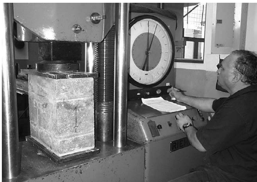
Figura C.A.2.1. Ensayo de prisma a compresión.
